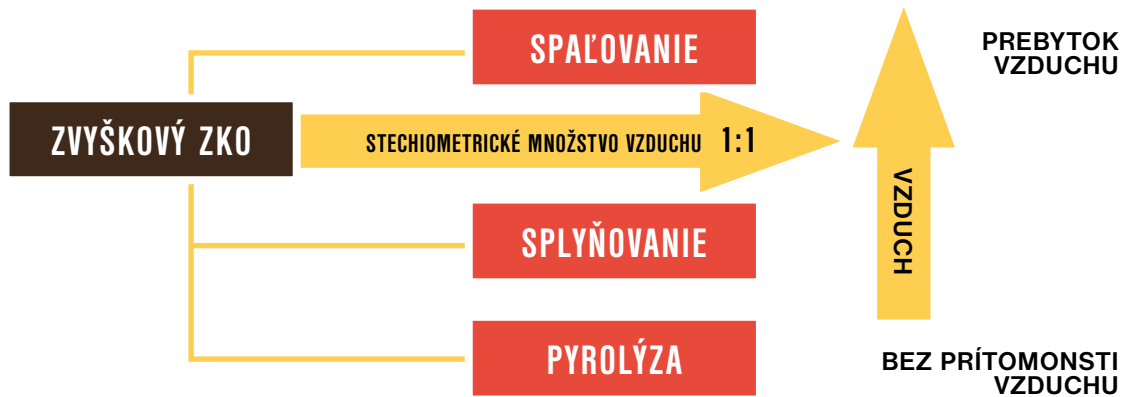
Obr. 25: Rozdelenie termických procesov na zhodnocovanie komunálneho odpadu podľa koncentrácie kyslíka pri spaľovaní, [24].
